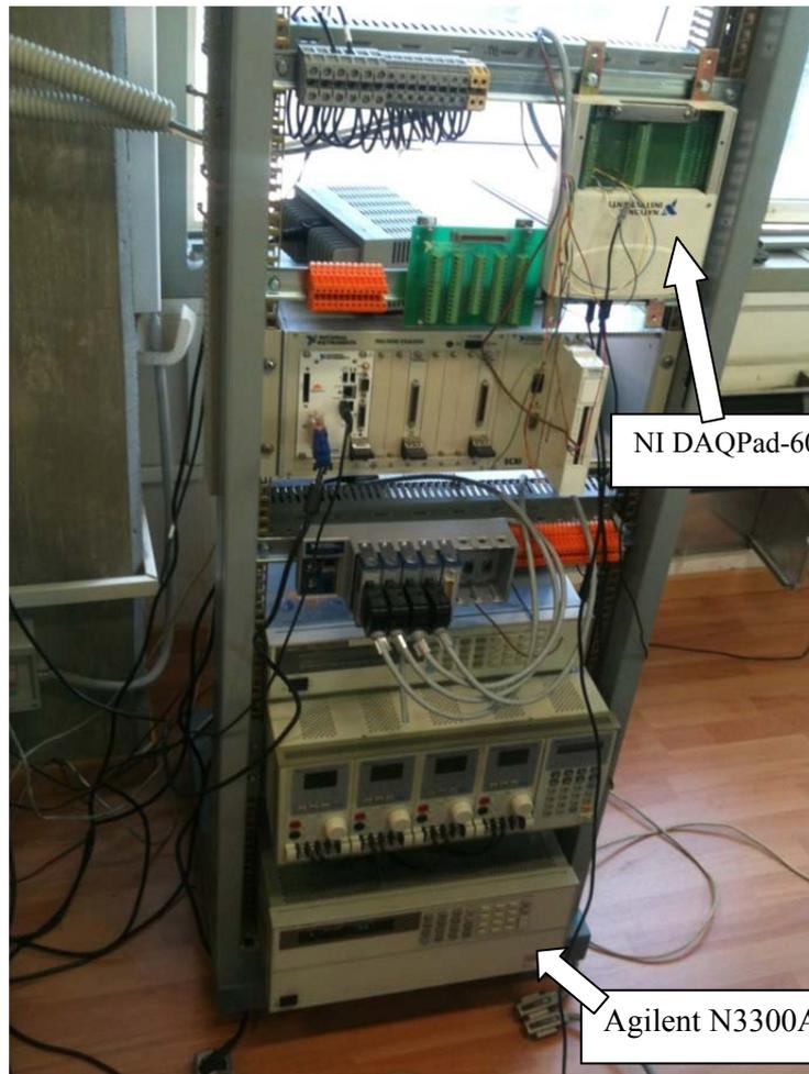
Figure A.4. Banc expérimental pour l'obtention de la courbe I-V.
