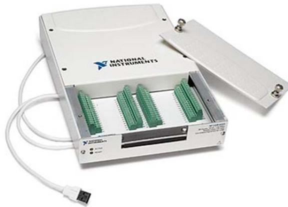
Figure A.8. Carte d'acquisition de type : NI DAQPad-6015.
