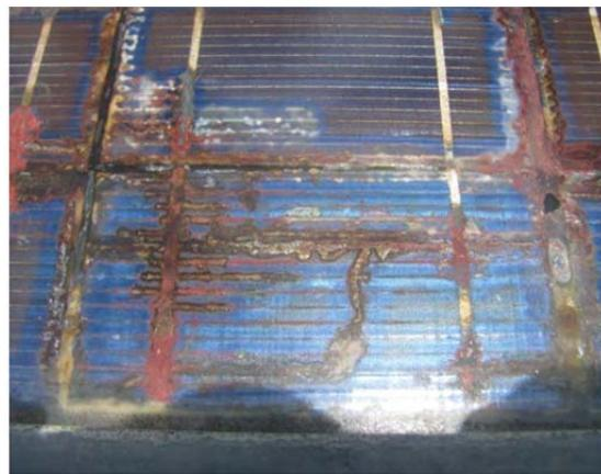
Figure.C.8. Corrosion due à l'humidité.
