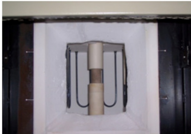
FIGURE 4.8 – Image de l'essai de compression à chaud sur la machine MTS.
