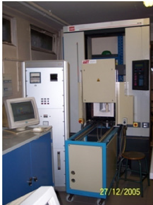
FIGURE 4.7 – Machine d'essais mécaniques MTS 30/ML.
