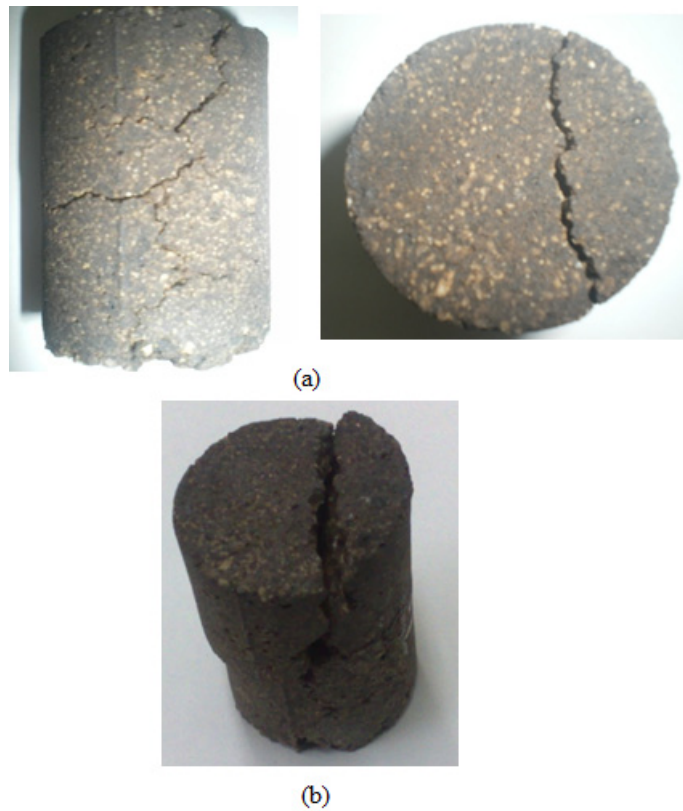
FIGURE 6.28 – Images représentant un échantillon de béton choqué thermiquement : (a) Vue de profil et vue supérieure d'un échantillon après 70 cycles ; (b) échantillon après 80 cycles
