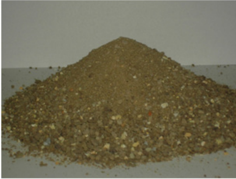
FIGURE 4.13 – Image de grains de Chamotte de kaolin DD3.
