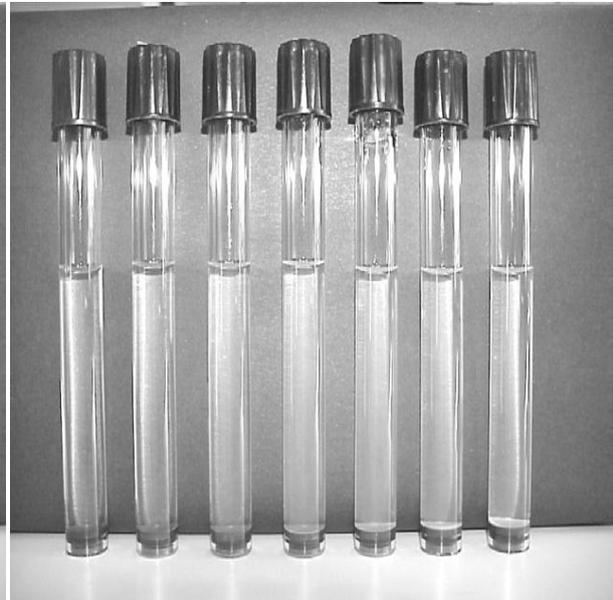
**Figure III.6:** Séparation de phase obtenue à différents ratios Pr : Ps de mélange gélatine/ Na CMC/eau à 1%, après 5 jours à pH (a) 6,8, (b) 7,8 et (c) 8,3.
