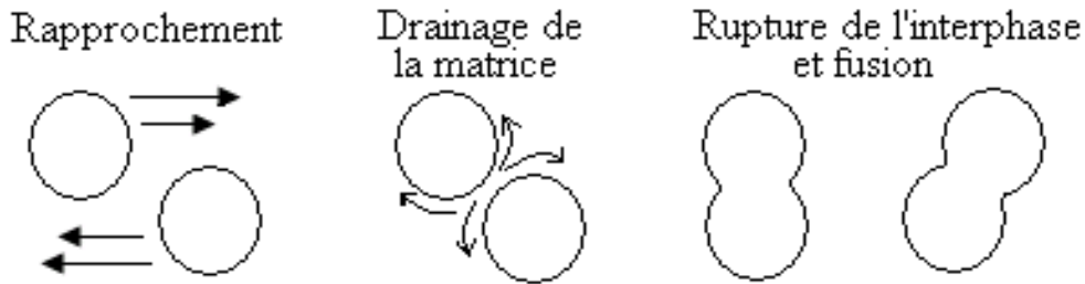
Figure I-4 : Découpage du processus de coalescence en étapes élémentaires [22]
