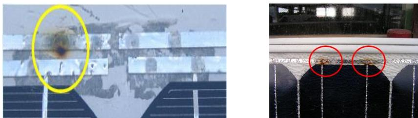
**Figure III.7:**défaut d'augmentation de la résistance  $R_s$ .
