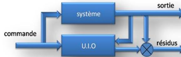
**Figure I.11 :** Génération des résidus par les UIO.
