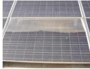
**Figure III.4 :** défaut de délaminage.
