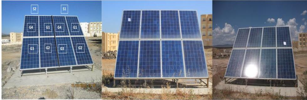
**Figure IV.27:** connexion série-parallèle avec et sans ombrage partiel.
