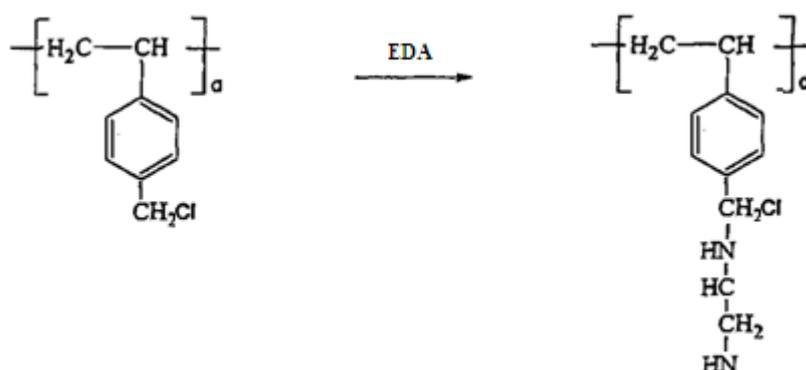
**Figure VI. 41 :** Schéma de la réaction de synthèse de la résine PS modifiées, voie (II).
