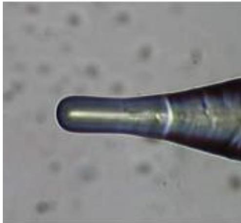
Figure II.17. Microcollimateur fabriqué par l'attaque chimique et fusion thermique [20].
