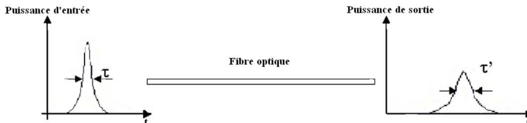
Figure I.12. Evolution d'un signal lumineux à travers une fibre optique.
