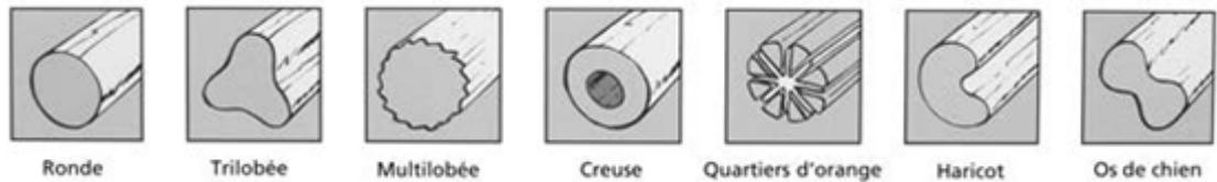
**Figure IV 8** Sections les plus courantes des filaments.[48]
