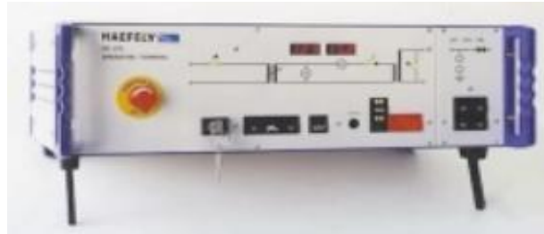
Figure 3.2 Contrôleur du transformateur de régulation
