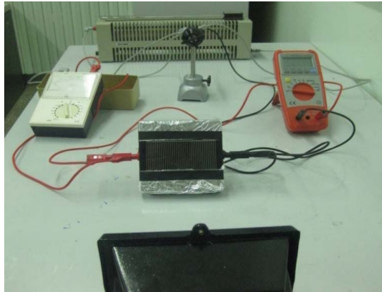
Figure III.6 : Présentation de l'installation utilisée pour mesurer le rendement photovoltaïque.
