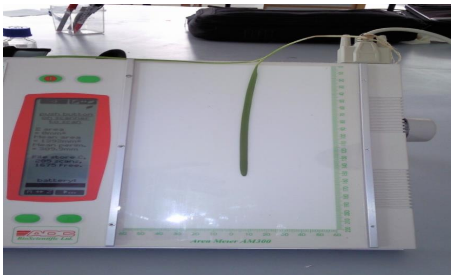
Figure 5. Planimètre électronique utilisé pour mesurer la surface foliaire (Area meter AM 300, (photo prise par Hamli, 2015).
