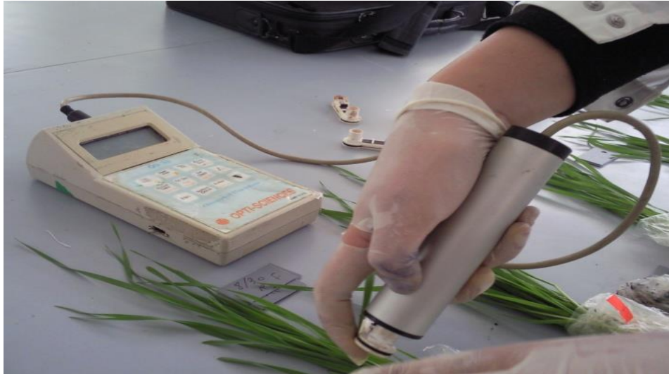
Figure 6. Fluoromètre Opti-Science 30 utilisé pour la mesure de la fluorescence (Photo prise par Hamli, 2015).
