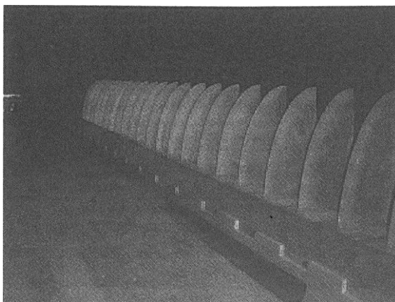
Fig. 15 : Vue du système de déclenchement de la couche limite
