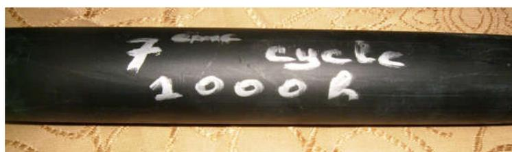
**Figure V-20 : Photo d'un échantillon du 7<sup>ème</sup> cycle soumis à l'essai de pression pendant 1000 h.**
