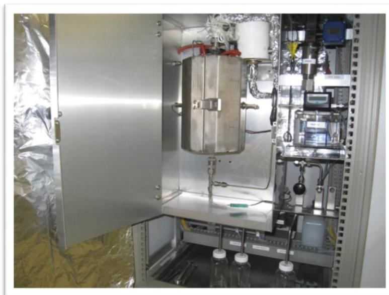
**Fig. II.12:** (Vue de Face) nous avons ouvert la porte du bâti catalytique et nous voyons au premier plan le four du réacteur. A droite nous avons un gazomètre pour mesurer le débit total des gaz lors des expériences.
