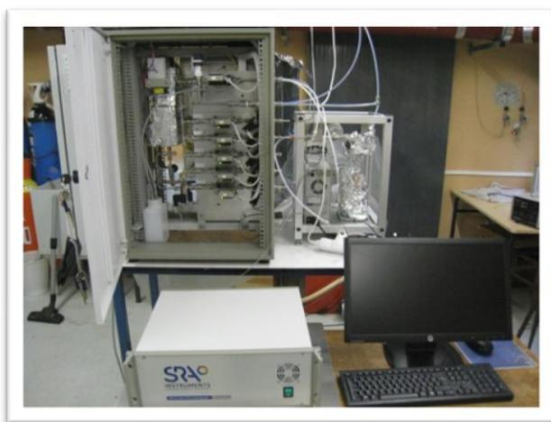
**Fig. II.11:** On voit l'arrière du bâti catalytique avec toutes les arrivées de gaz et les débitmètres massiques. Sur la gauche, de forme parallélépipédique, c'est le piège à effet Pelletier pour piéger l'eau. Devant, au premier plan c'est le micro-GC avec le système informatique
