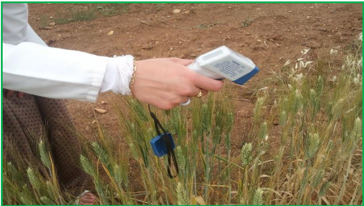
Figure 8. Mesure de la température de la canopée (ITGC, Sétif).
