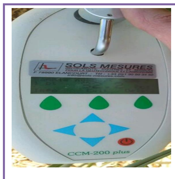
Figure 7 : La mesure de chlorophylle par le SPAD (CCM-200 plus).
