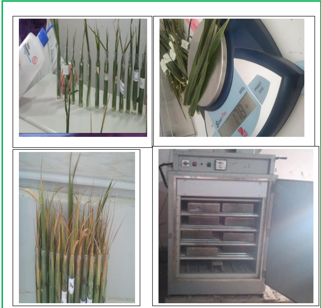
Figure 9. Les étapes de mesure de la teneur relative en eau (Laboratoire CNCC, Sétif).
