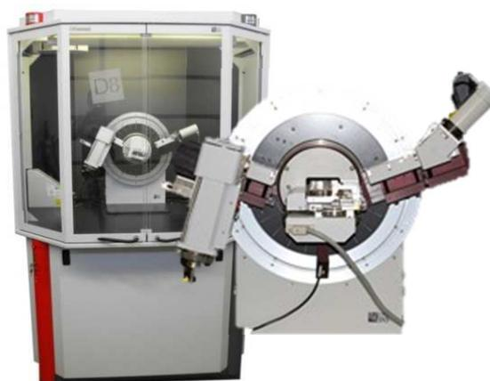
Fig. 4.20: Diffractomètre Bruker D8 Advance
