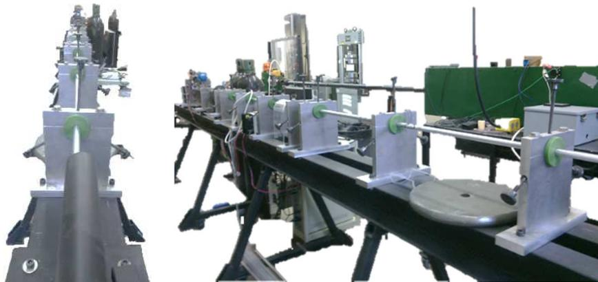
Fig. 1.13: Vue générale du dispositif des barres d'Hopkinson
