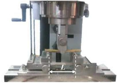
Fig. 3.86: Essai de flexion 3 points
