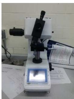
Fig. 3.58: Duromètre CM-800AT
