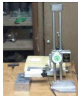
Fig. 4.9: Rugosimètre
