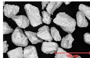
Fig. 3.55: Micrographies MEB de la poudre Amdry 5843 projetée [57]
