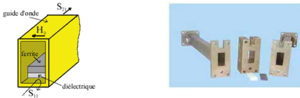
Figure III. 5 : configuration de mesure par guide d'onde
