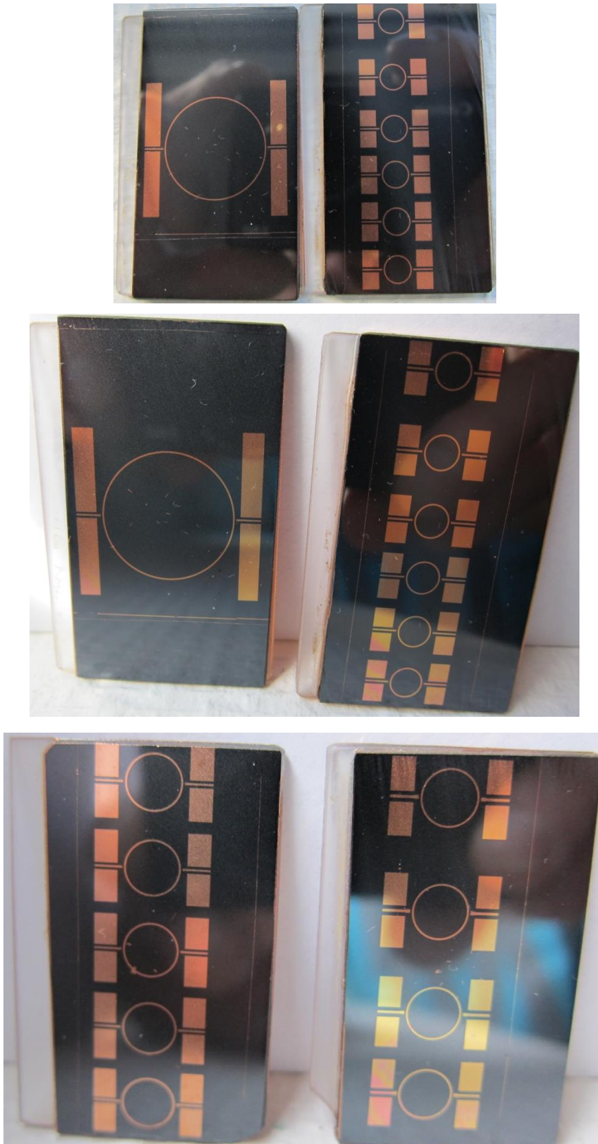
Figure V.8: Dispositifs du MSRR A, B et C, réalisés au labo LT2C
