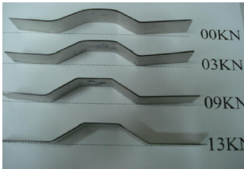
Figure 1-17. Retour élastique pour différents efforts de serrage sur un acier doux (Ouakdi, 2012).
