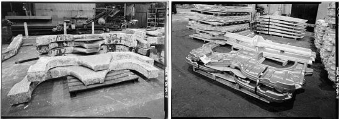
Figure 2-1. Des pièces en titane pour l'avion de combat McDonnell Douglas F-15 Eagle avant et après avoir été pressé par la presse à forger de 50 000 tonnes construite dans le cadre du "Heavy Press Program" et exploitée par Alcoa (doc_int5).
