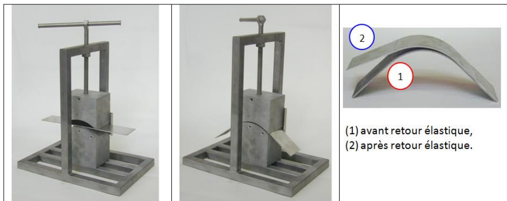
Figure 1-2. Exemple d'une opération de pliage d'une tôle métallique (Doc_int2).
