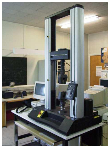
Figure 2-4. Machine de traction de type Instron 5569 de capacité 50 kN disponible au laboratoire SYMME.
