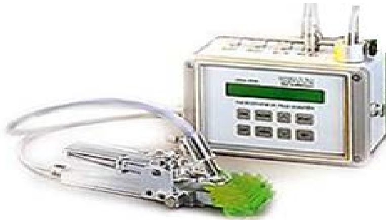
Figure 19. Fluorimètre PAM pour l'analyse du rendement de la photosynthèse (Mini PAM photosynthesis analyser)
