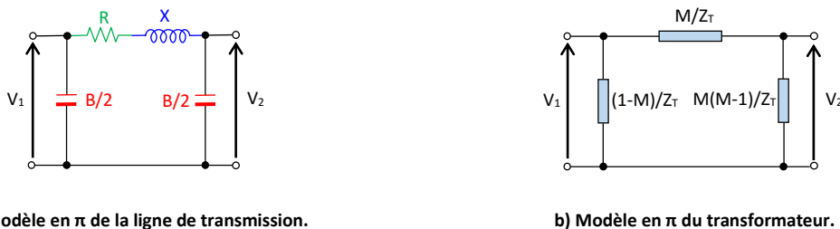
Fig. 2.4. Modèles en \pi de la ligne de transmission et du transformateur.
