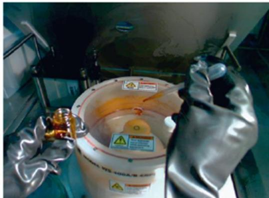
Figure.1. Schéma de principe d'un dépôt de couche mince à la tournette (spin-coating) (a). Photographie du système intégré à la boîte à gants (b).
