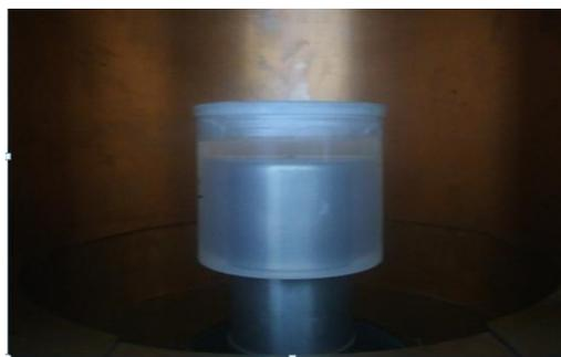
**Figure III-2:** Une vue ouverte montrant le détecteur et un conteneur type béccher Marinelli posé au-dessus du détecteur.
