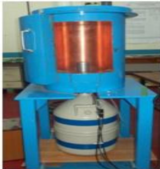
**Figure III-1:** Détecteur HPGe inséré à l'intérieure d'un blindage en plomb avec une couche en cuivre
