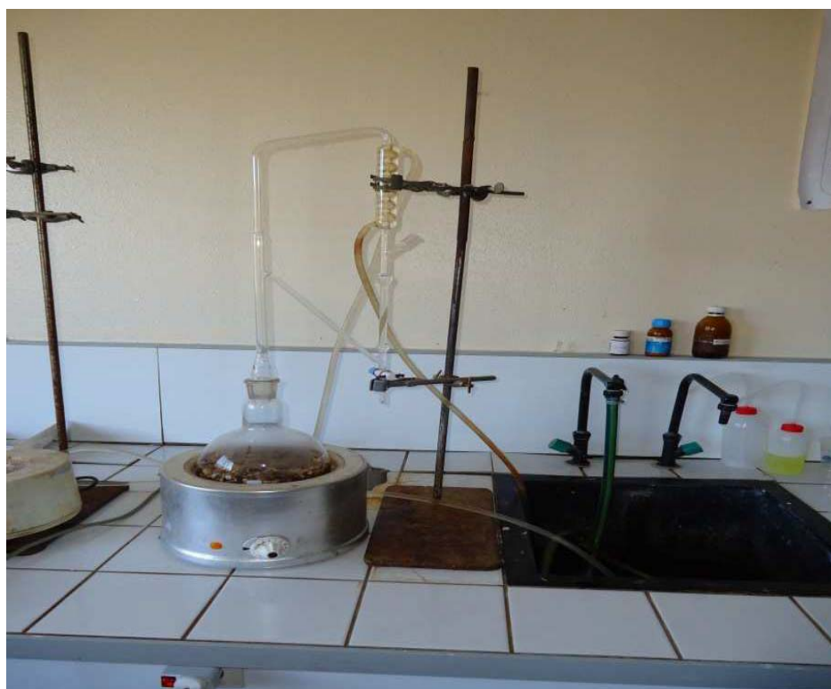
Figure 24: Appareil d'extraction des huiles essentielles type Clevenger.
