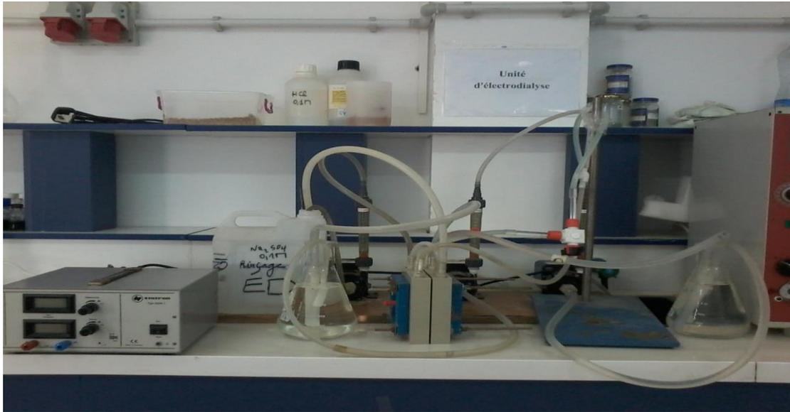
**Figure IV.5 : Pilote d'électrodialyse**
