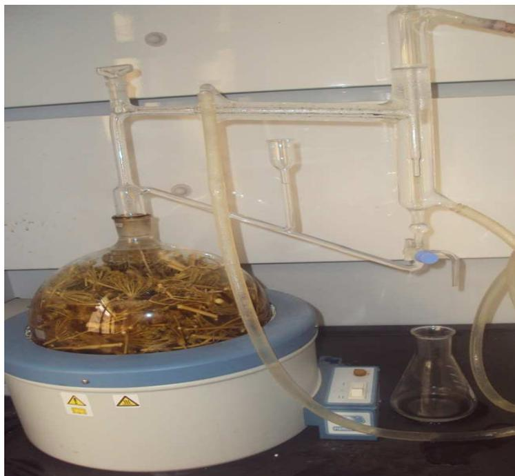
**Figure 15** : Appareil de distillation type Clevenger.
