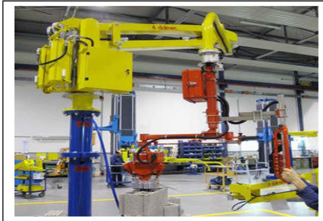
**Figure III.1** Bras manipulateurs dans une industrie automobile
