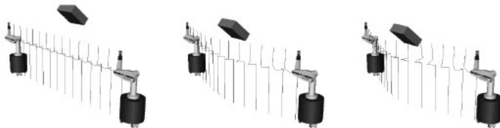
**Figure III.18** Déformation de chemin : le chemin suivi par un robot mobile est modifié itérativement au cours du mouvement afin de s'écarter de la position d'un obstacle s'en approchant
