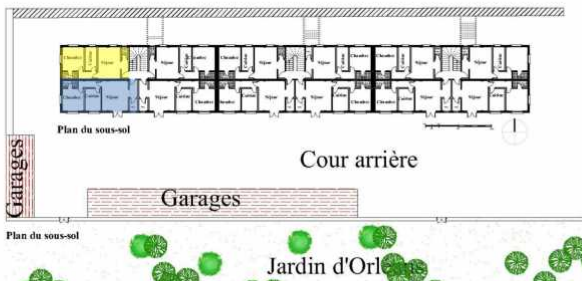
Figure 79 : L'immeuble Brincat (2). En sous-sol, l'épaisseur de la barre est divisée en deux. Les appartements F2 sont soit orientés vers la rue, soit vers le jardin.
