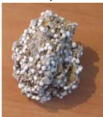
Figure 19 : Échantillon de béton cellulaire au polystyrène expansé, Retrouvé dans le chantier de réhabilitation du lycée Med Kerouani (2010)
