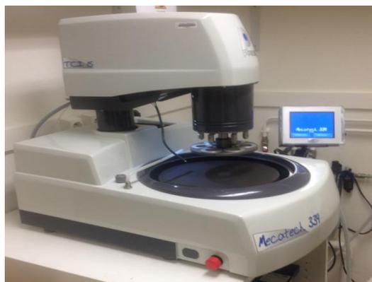
Figure III.6 : Machine de polissage
