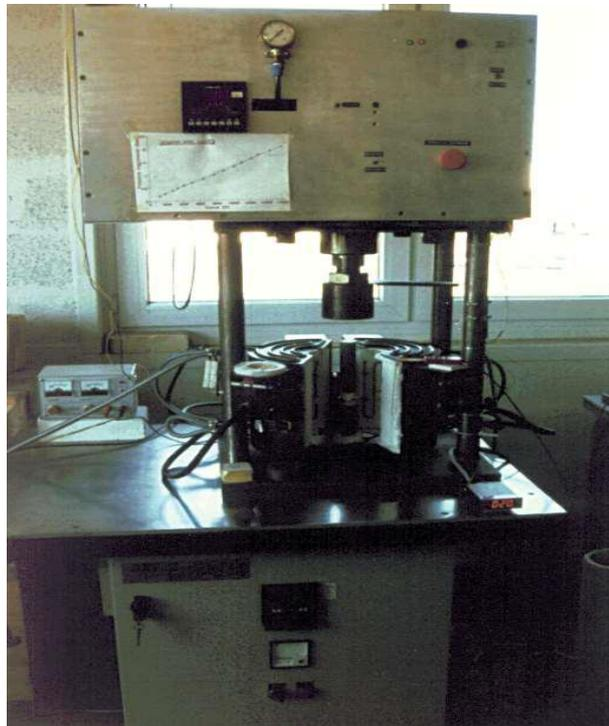
Figure II .7 : Dispositif de pressage et forgeage à chaud [VINC 1997].
