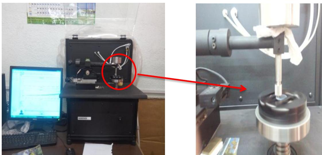
Figure III-15:Tribomètre Nanovea utilisé.
