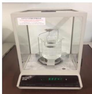
Figure III.17 : Illustration du montage de mesure de la densité
