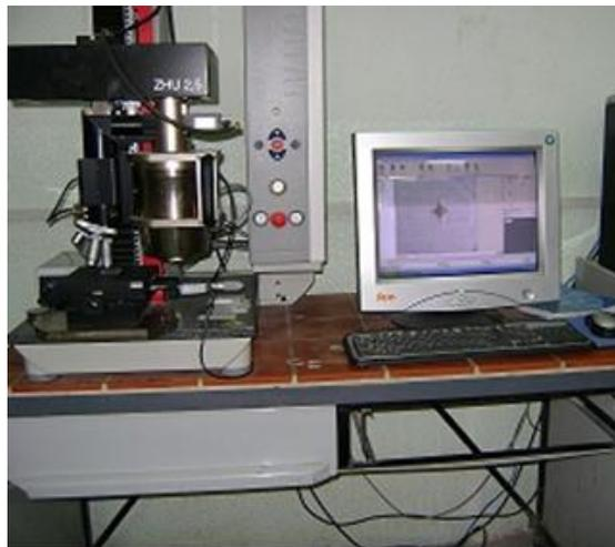
Figure III.13: Microduromètre instrumenté de type Zwick
