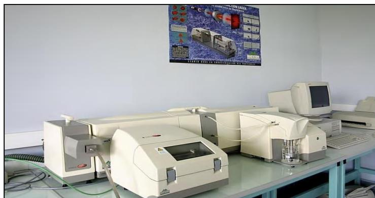
Fig. V.1 : granulomètre mastersiser 2000
