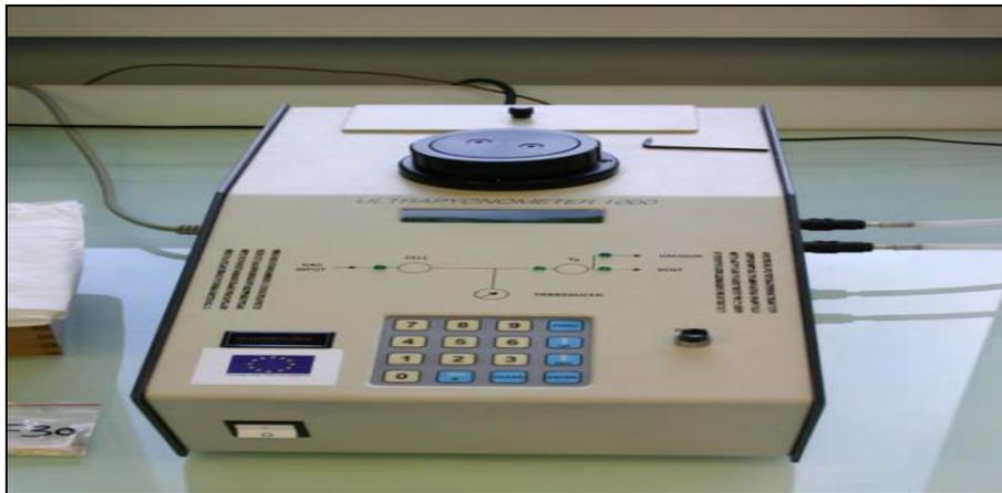
Fig. V.2 : pycnomètre à gaz d'argon
