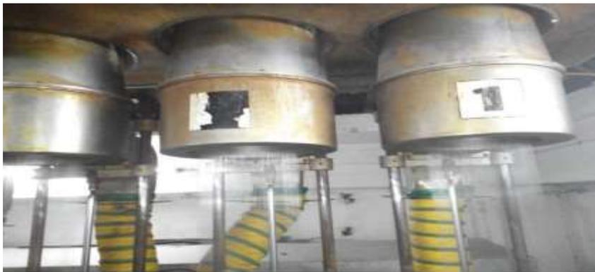
**Figure I-16.** Refroidissement des filaments [97].
