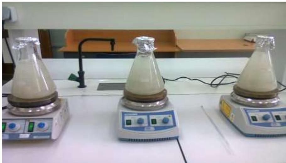
**Figure II-2.** Montage du traitement de surface de la perlite.
