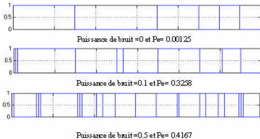
Figure 3.16 : comparateur à seuil montre bien l'effet de bruit sur la probabilité d'erreur .
