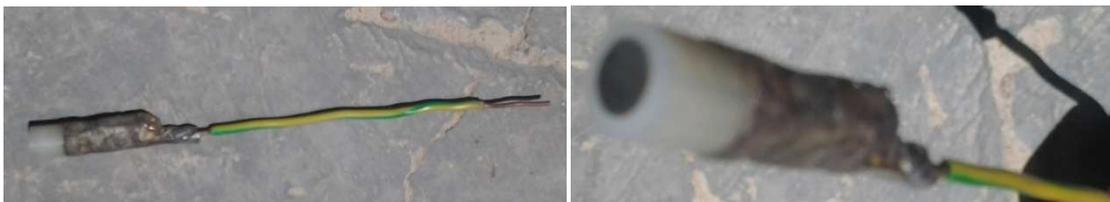
**Figure IV.2** : Électrode de travail utilisée au cours de l'étude électrochimique.
