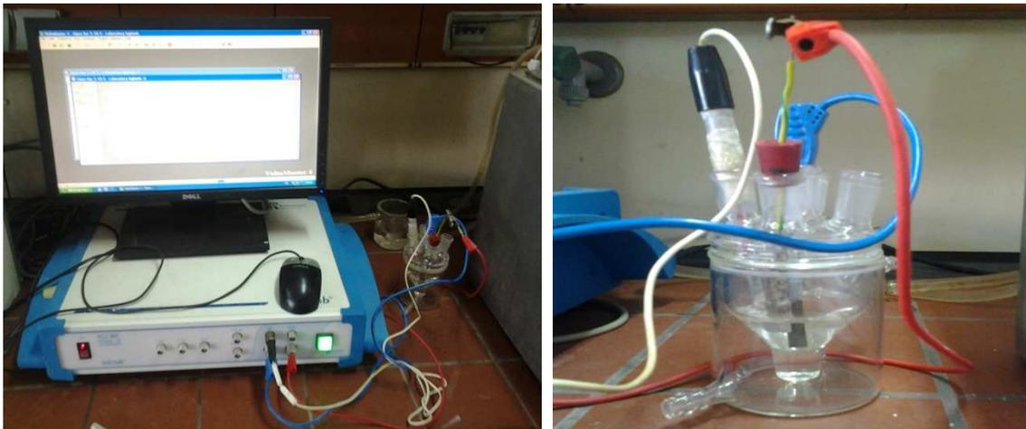
**Figure IV.3 :** Dispositif expérimental utilisé lors des mesures électrochimiques.
