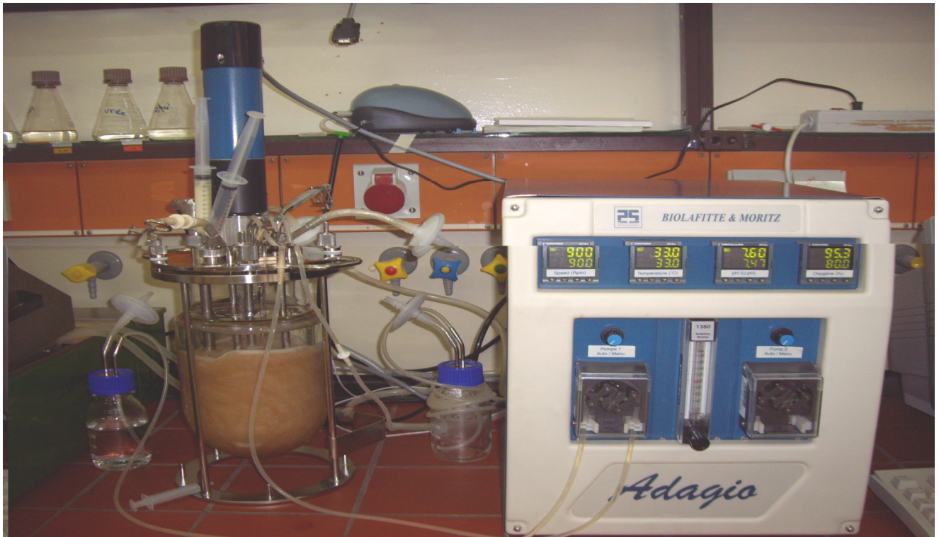
Figure II.2. Description d'un fermenteur (BIOLAFITTE & MORITZ) avec ses capteurs.
