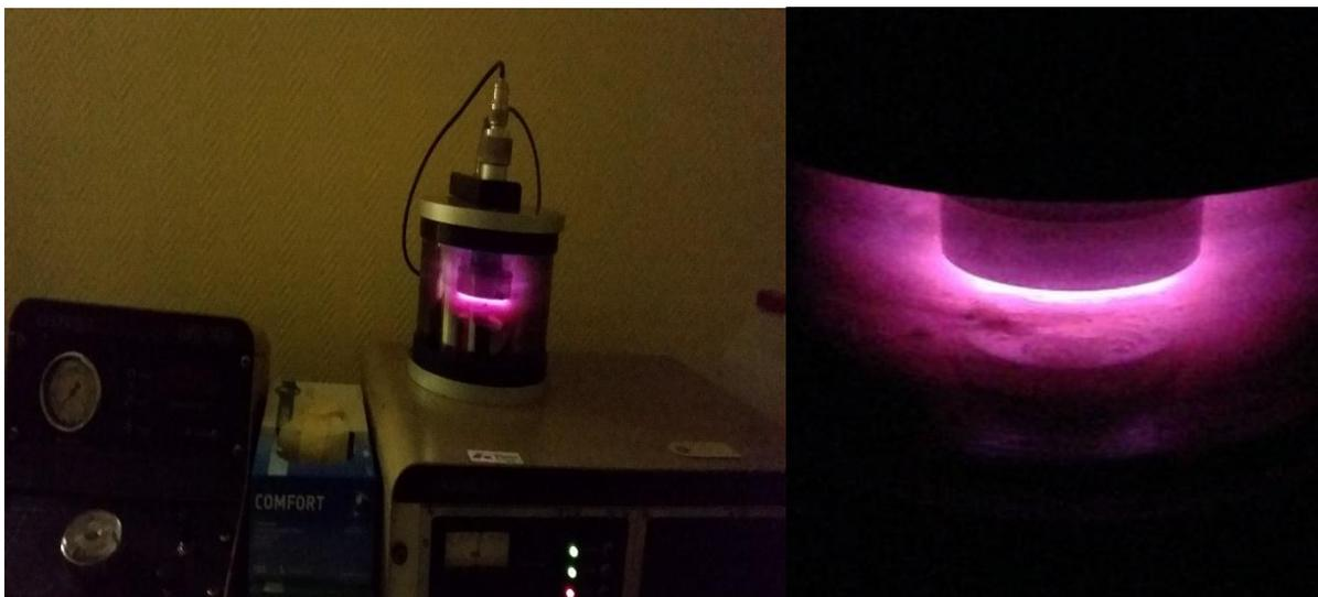
Figure 4.20 : Principe de la métallisation sur les échantillons utilisés
