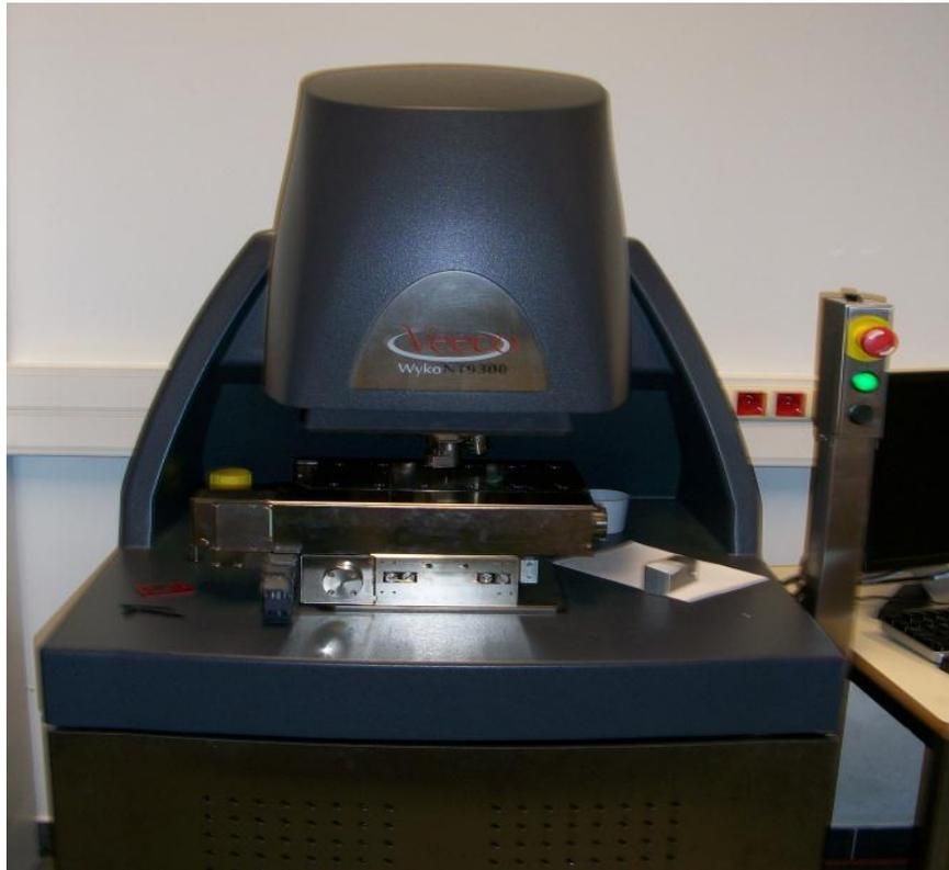
Figure 4.11 : Profilomètre optique de type Veeco (Wyko NT9300).
