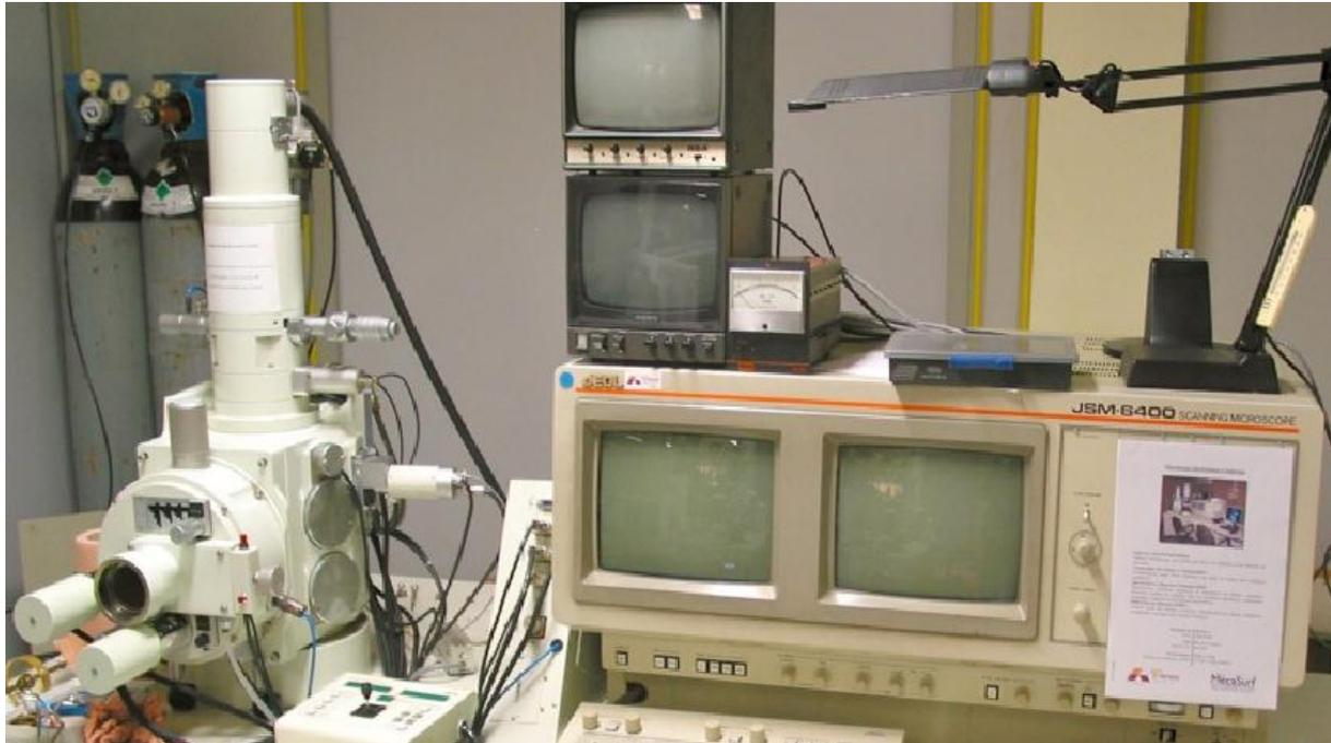
Figure 4.18 : Microscope électronique à balayage conventionnel Hitachi S-520
