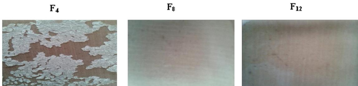
**Figure V.2 :** Images optiques des films préparés à partir des échantillons contenant 3.2% de peroxyde dans les trois systèmes.
