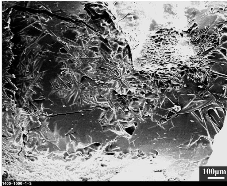
**Figure 6.13:** Faciès de rupture en traction indirecte à 1000°C.
