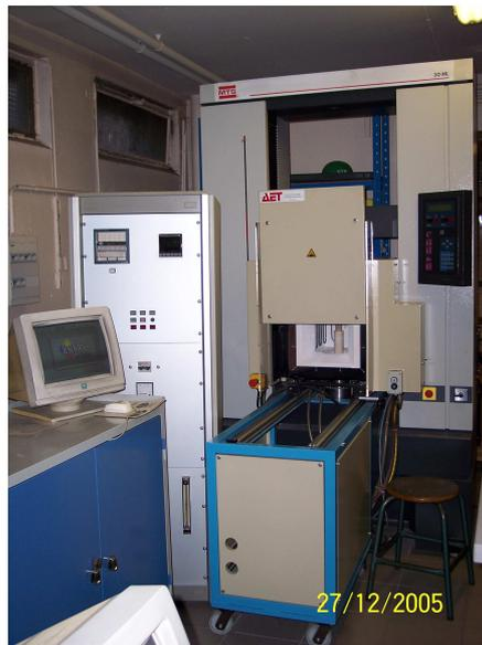
Figure 4.28: Machine d'essais mécaniques MTS 30/ML.
