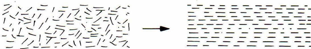
**Figure 4.17:** Représentation schématique des plaquettes au repos et en mouvement [Joue 01].
