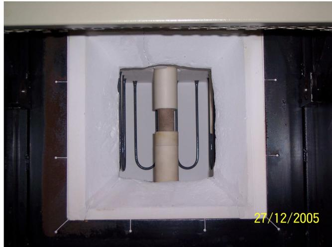
**Figure 4.29:** Essai de compression sur la machine MTS.
