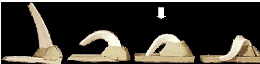
**Figure 1.1** : Cônes après chauffage à différentes températures.
