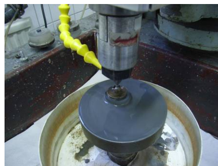
6.18 : Contact entre l'échantillon et le rodoir lors de la mesure du coefficient de friction en doucissage par abrasifs libres
