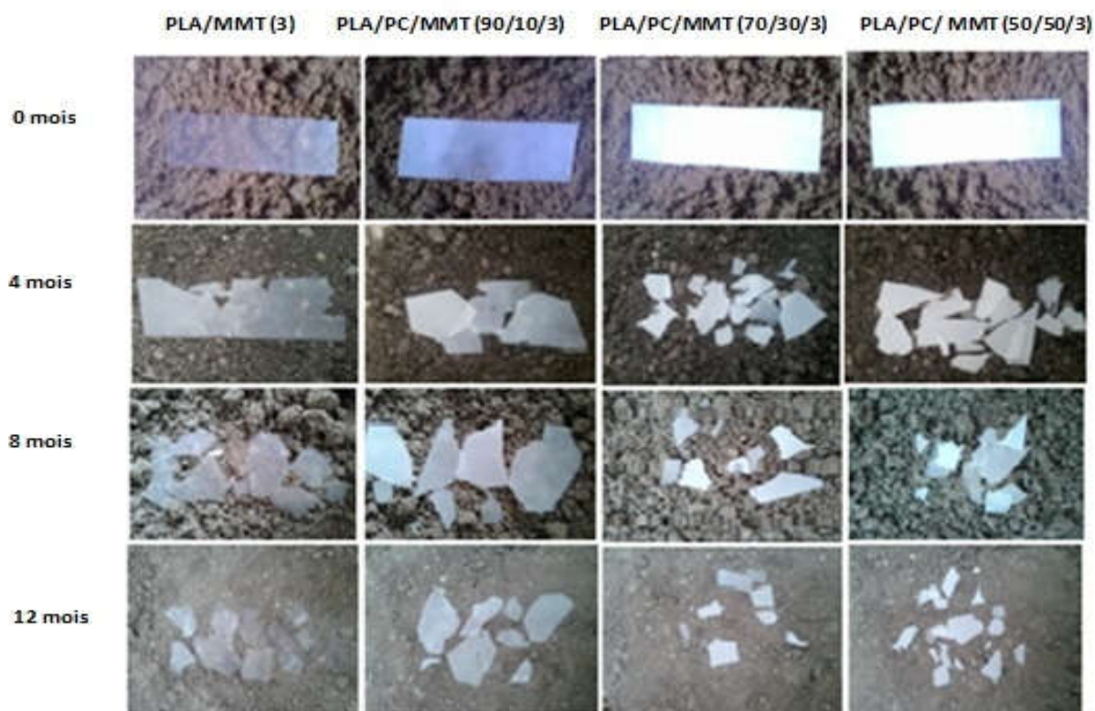
Figure IV.14 Photographies illustrant l'évolution de la biodégradation des nanocomposites à matrices PLA et mélanges PLA/PC non catalysés
