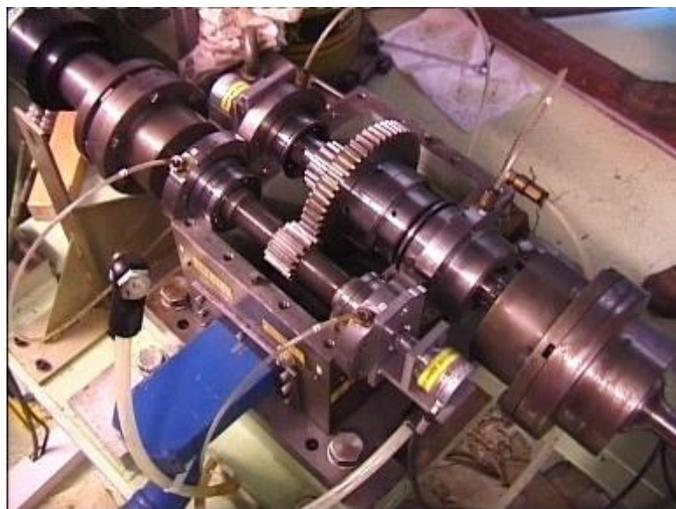
Figure 4.11: Arbres d'entrée et de sortie avec engrenages et leurs roulements
