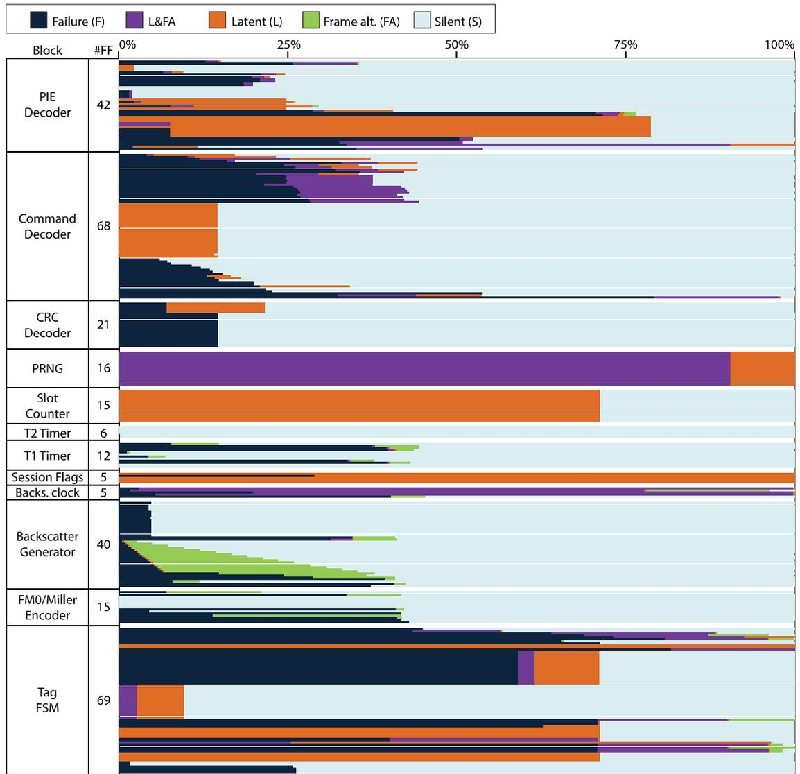
Figure 4-7 Classification des SEU injectées pour chaque bascule du tag.
