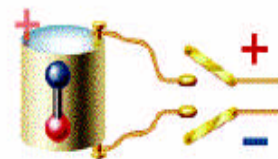
Effet indirect : L'application d'une tension engendre une déformation
