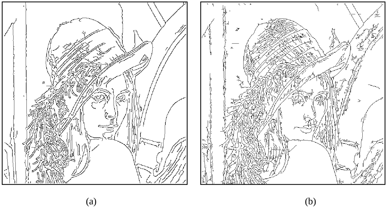
Figure (2.1) : Extraction des contours par : (a) L'opérateur Canny , (b) Phase Conguency
