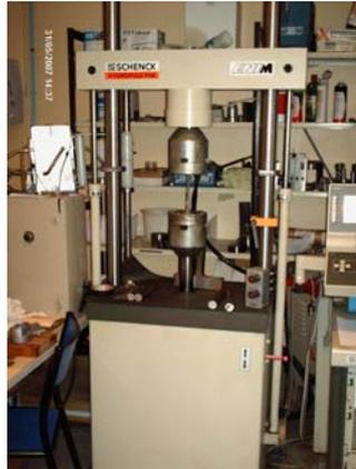
**Fig. 2** : Banc d'essais de fatigue traction-traction "SCHENK "
