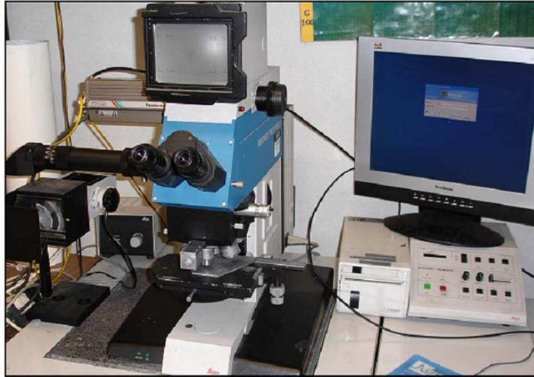
**Fig.24** : Microscope optique pour l'observation des structures sandwichs
