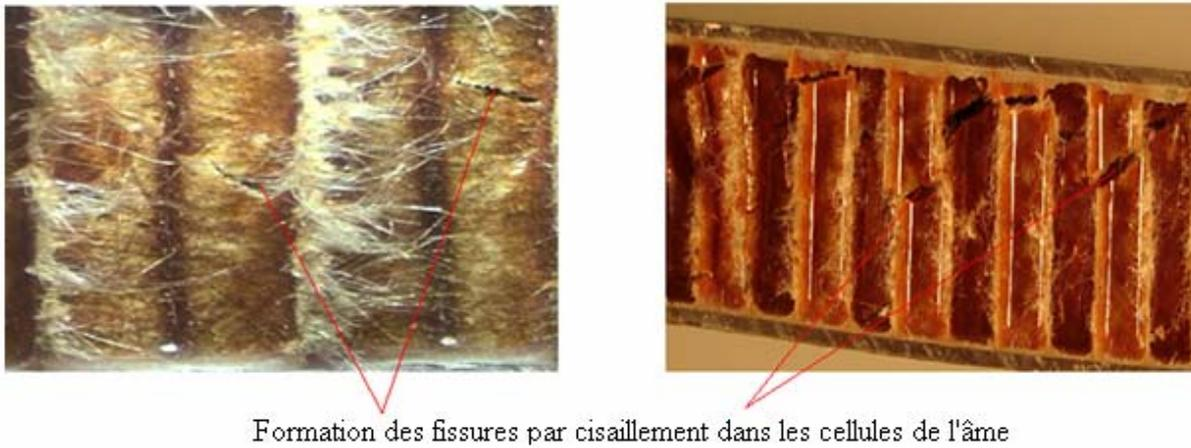
**Fig. 31** : Formation des fissures par cisaillement dans les cellules de l'âme de densité  $48 \text{ kg/m}^3$ , sens W
