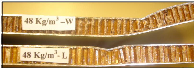
**Fig .74** : Mode de rupture de plaques sandwichs Alu-Nomex, de densité  $48 \text{ kg/m}^3$  pour les deux configuration L et W (a),(b)
