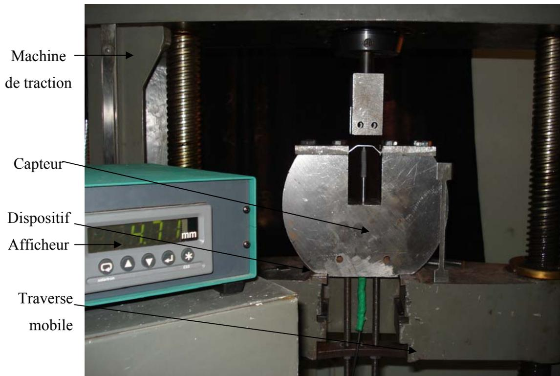
**Fig. IV.3.** Dispositif d'étirage - pliage monté sur la machine de traction.
