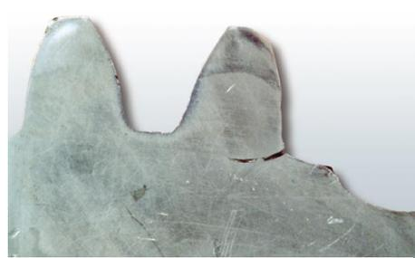
**Figure 3.7b** Défaut de fissure au pied d'une dent d'engrenage
