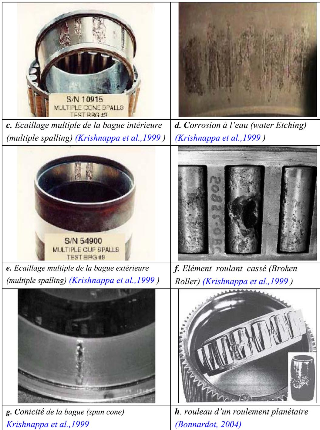
**Figure 3.10** Quelques Types de défauts de roulement
