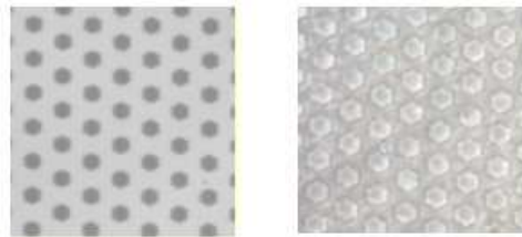
Figure.III.3 : Une section du masque photo-lithographique utilisé dans le processus de fabrication du réseau de diffraction.
