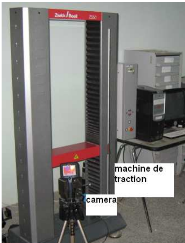
Fig. 4.13. Machine de traction avec la caméra thermographique.
