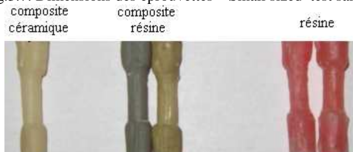
Fig.3.8- Formes des éprouvettes en composite céramique, composite résine et résine
