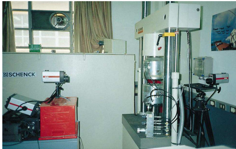
Fig.1.5. Deux scanners thermiques sont utilisés dans la détection de la température sur les deux côtés de l'éprouvette.
