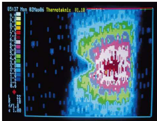
Fig. 1.7. Concentration de contrainte pendant le chargement dynamique sur une éprouvette entaillée [5].
