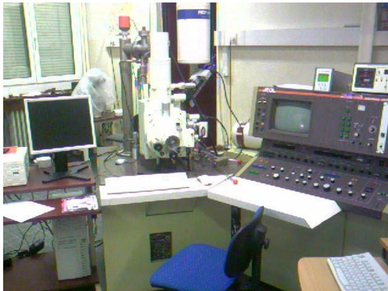
**Figure V.27 :** Appareillage utilisé pour les mesures EDS.
