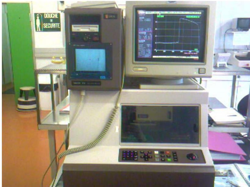
**Figure V.30 :** Appareillage de mesure des épaisseurs (Profilomètre TENCOR).
