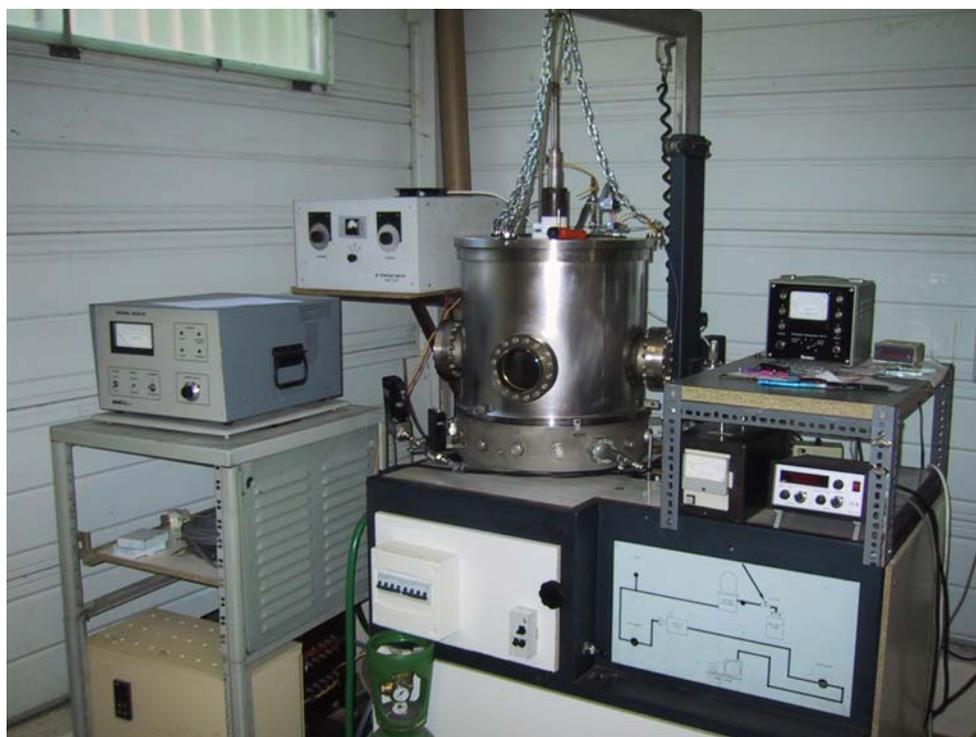
Figure V.12 : Dispositif expérimental du pulvérisateur cathodique.
