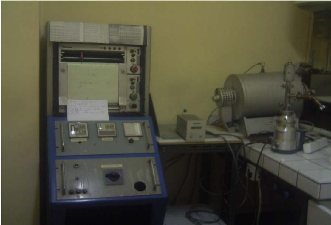
**Figure V.6-a :** Four à refroidissement lent programmé du bain fondu.
