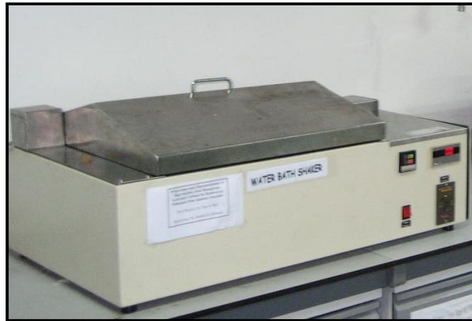
**Figure 2. 8** Photographie d'agitateur thermostaté.
