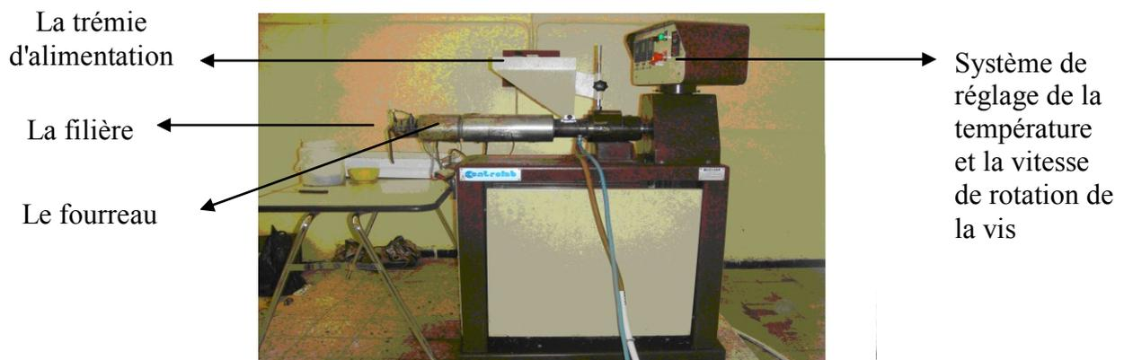
**Figure 3.7 :** L'extrudeuse
