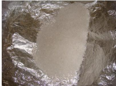
**Figure 3.1:** Vue globale du polycarbonate granulé utilisé.
